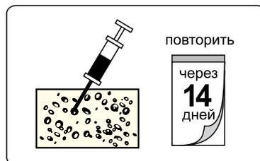
При уже начавшемся биопоражении состав следует вводить внутрь древесины методом шприцевания.
