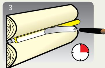
Еще одним важным элементом в подготовке деревянных поверхностей к финишным покрытиям – является **грунтование**. Чаще всего специальные грунтовки по дереву одновременно являются и антисептиками, продлевая сроки службы древесины и защищая ее от образования плесени, грибков и вредного воздействия окружающей среды.
